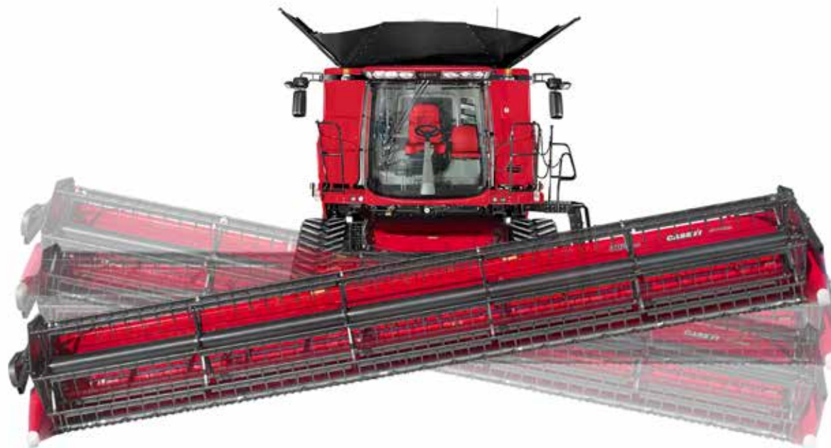
La technologie Terrain Tracker de Case IH assure une hauteur de coupe exacte et uniforme, même sur les terrains les plus irréguliers.
