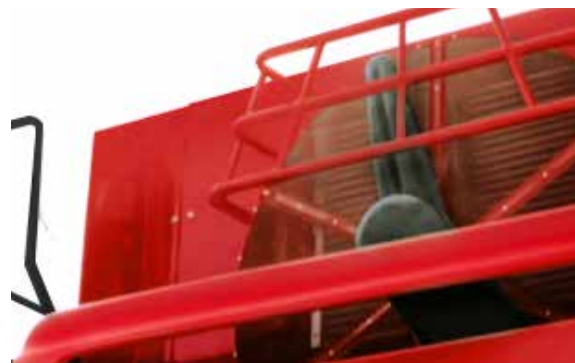
Brosse rotative pour dépoussiérage optimal.
