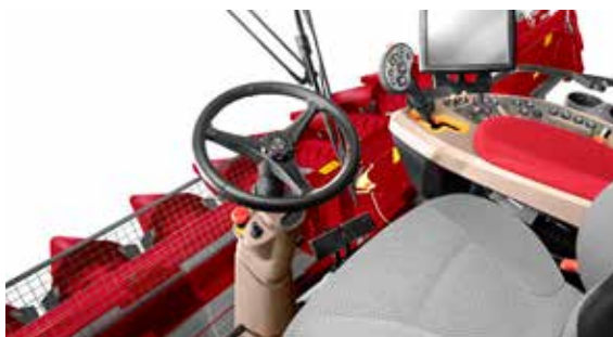
Colonne de direction repliable, avec nouveau bouton d'urgence et volant télescopique – champ de vision parfaitement dégagé
