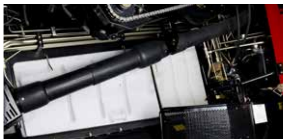
L'entraînement Power Plus transfère la puissance à l'élévateur et la barre de coupe. Conception simple, entretien minime.
