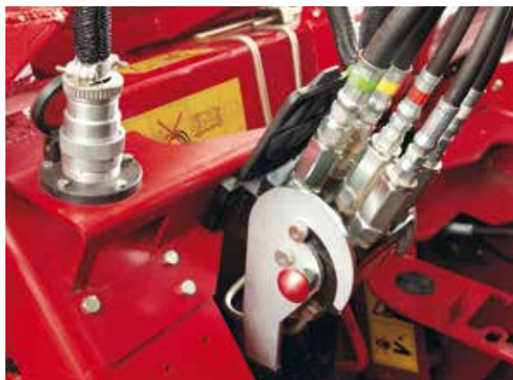
Montez la barre de coupe en un clin d'œil avec le loquet unique qui relie tous les circuits hydrauliques et électriques
