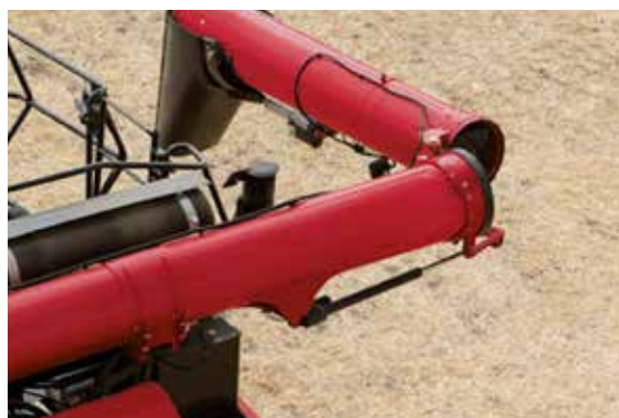
Les vis de vidange de 8,8 m et 10,4 m sont disponibles en version repliable pour un transport plus sécurisé sur route et pour faciliter les manœuvres de remisage sous hangars
