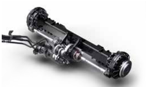
Nouvel entraînement et nouvelle transmission hydrostatiques, pour une meilleure traction. Les freins à bain d'huile offrent une puissance de freinage constante
